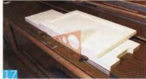
**17** Важный момент – разметка и сверление отверстий в стойках и фасадах под «ввёртёные» петли.
