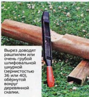
Вырез доводят рашпилем или очень грубой шлифовальной шкуркой (зернистостью 36 или 40), обернутой вокруг деревянной скалки.
