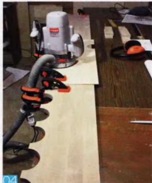
нял в два приёма — сначала на половину толщины, после чего фрезу погружал на всю толщину.
