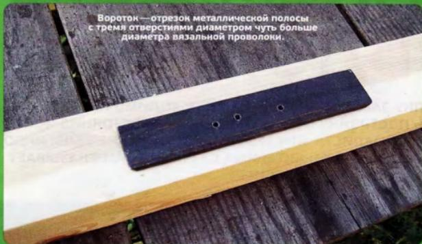
Вороток — отрезок металлической полосы с тремя отверстиями диаметром чуть больше диаметра вязальной проволоки.
