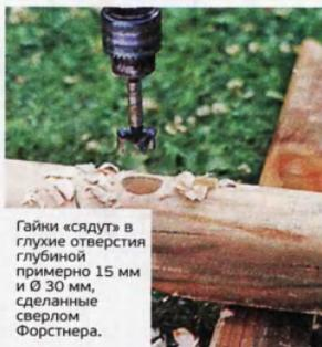
Гайки «сядут» в глухие отверстия глубиной примерно 15 мм и Ø 30 мм, сделанные сверлом Форстнера.
