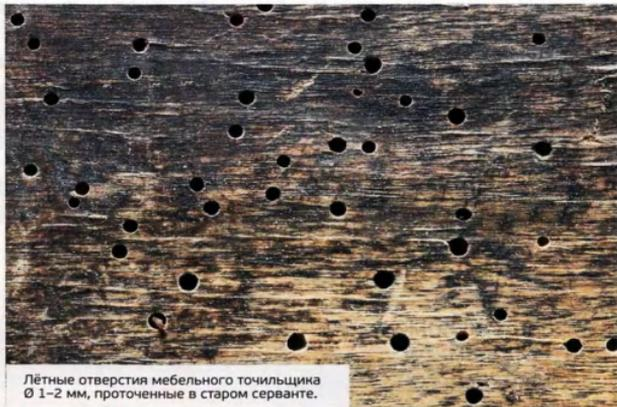
Лётные отверстия мебельного точи́льщика Ø 1–2 мм, проточенные в старом серванте.
