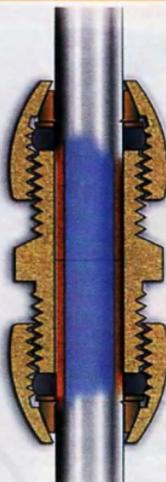
Так соединяют только гладкие трубы. Внутренний диаметр обжимного кольца должен подходить к наружному диаметру трубы. При раскрое медных труб по длине следует обратить внимание на перпендикулярность торца к оси трубы. Образующиеся заусенцы следует тщательно удалить.
