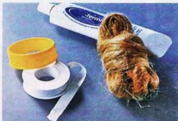
Правильно намотанный на резьбу лён и нанесённая паста обеспечивают герметичность резьбовых соединений. Впрочем, для уплотнения иногда проще использовать тefлоновую ленту. Классическое же уплотнение — сантехнический лён и уплотнительная паста.
